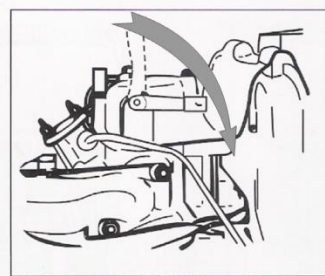
8. Ábra – A 1001KSD rotációs kapagép motorjának elindítása
